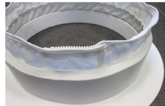
El conector de collar rápido permite realizar de manera más eficaz y accesible el montaje y desmontaje de los ductos textiles. El cuello se conecta directamente a la unidad de tratamiento de aire y queda perfectamente fijado, impidiendo que exista algún desprendimiento. Para retirar el cuello únicamente debemos hacerlo como se muestra en las imágenes.
