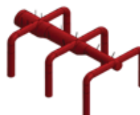
Conducto principal, con dos reducciones, seis injertos y codo de 90°.
