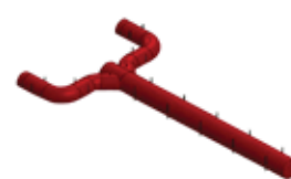
Dos entradas de aire con codos de 90° y 45°.
